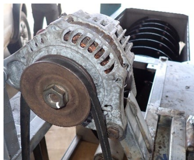
Fig.2 オルタネータ Alternator
